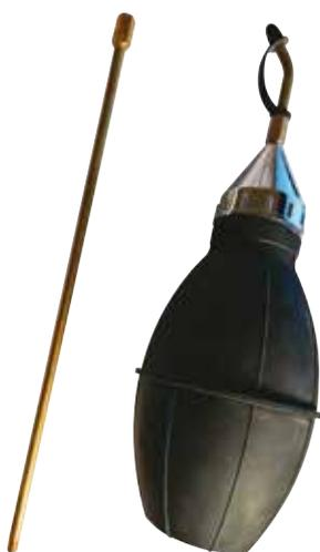
Soffietto in gomma con ugello in ottone per la distribuzione di formulati in polvere. Con serbatoio a due valvole di aspirazione delle polveri, in alto e in basso, che consentono di soffiare le polveri sia verso il basso che l'alto. Dotato di una prolunga per l'ugello che consente di trattare anche i punti più difficilmente raggiungibili.
