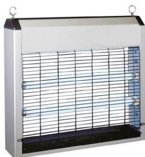
Trappola elettroluminosa bifacciale in alluminio per insetti volanti. Può essere appesa al soffitto, utilizzando le apposite catenelle fornite in dotazione, ad un'altezza di circa 2-2,5 m. Dotata di cartone collante bifacciale di colore nero e di 4 lampade UV da 15 W cad.
